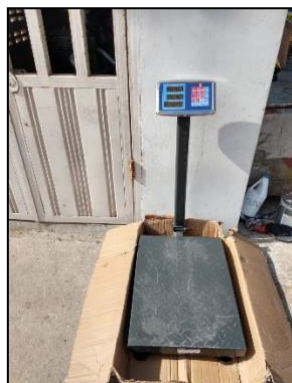
Balanza digital utilizada para el pesaje de los residuos.
