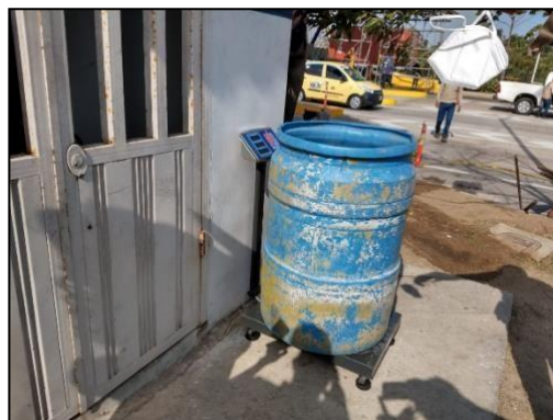
Balanza y recipientes para la determinación del peso y volumen de residuos no compactados.
